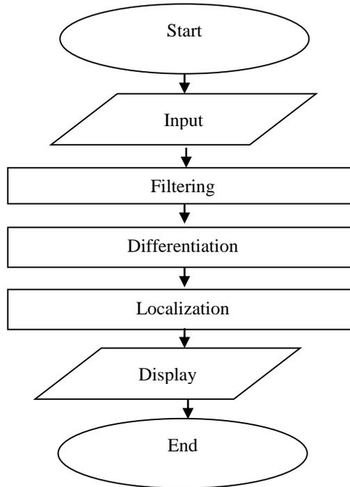
*Figure 2 Edge Detection Process*
