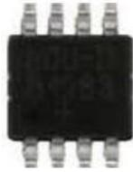
Fig 2. DS600 Temperature Sensor.
